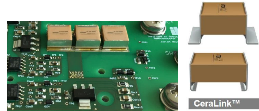
Kommutierungszelle eines DC/DC Wandlers
