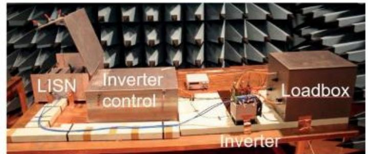
Messaufbau für leitungsgebundene Störungen nach CISPR25 [2]
